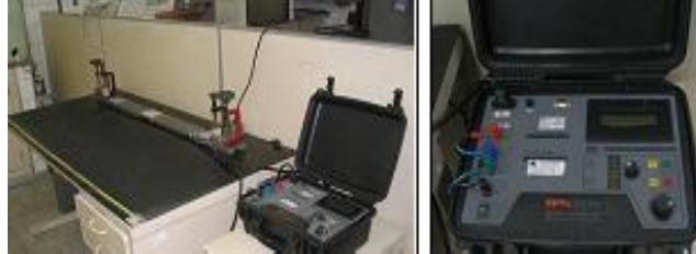
Figura 15 - Fotos do conjunto componentes da ponte de Kelvin utilizada para medir a resistência elétrica
