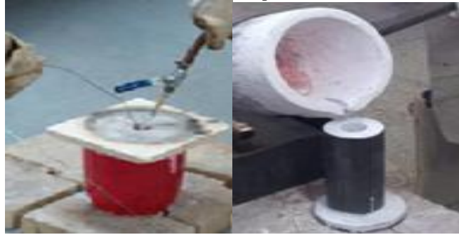
Figura 8 - Injeção de argônio e vazamento para retirar a amostra de testemunho
