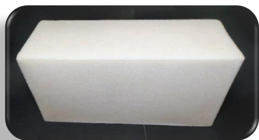
Figura 44 - Bloco confeccionado com molde de alumínio aço inox embalagem de álcool pós-consumo
