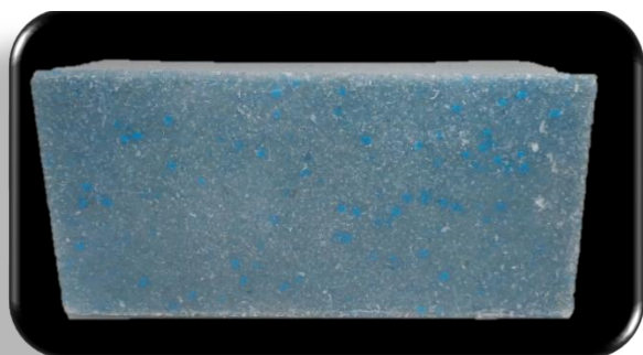
Figura 42 - Bloco confeccionado com molde de alumínio aço inox e garrafa de água mineral pós-consumo
