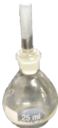
Figura 15 - Picnômetro de 25 ml
