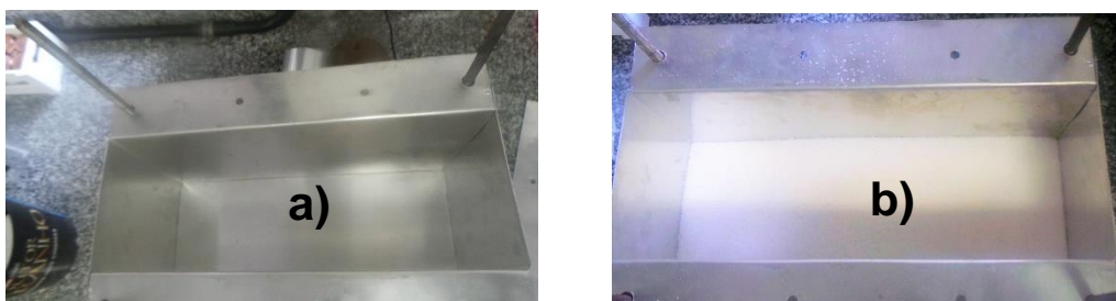
Figura 36 - Enchimento do molde com o Polímero a) molde vazio e b) molde com PEAD
