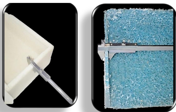
Figura 65 - Medição nas paredes externas dos blocos de PEAD e PP
