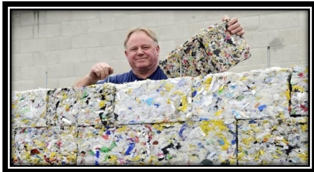
Figura B - ByBlock utilizando processo de compactação
