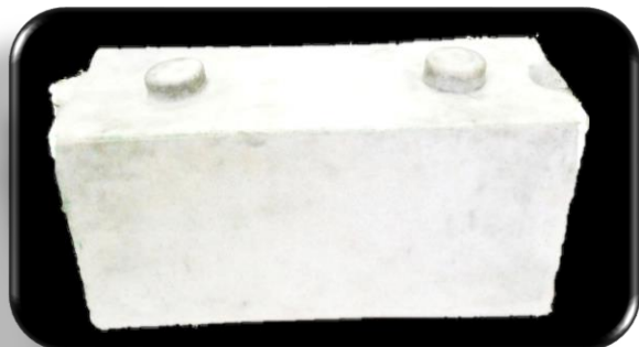
Figura 43 - Bloco confeccionado com molde de aço inox e embalagem de álcool pós-consumo
