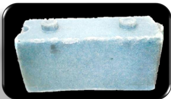
Figura 41 - Bloco confeccionado com molde de aço inox e garrafa de água mineral pós-consumo
