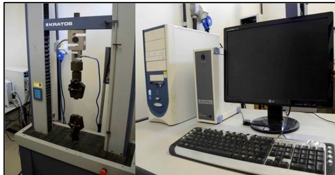
Figura 20 - Máquina de ensaio de tração KRATOS modelo IKCL1-USB acoplado ao computador com sistema de aquisição de dados.
