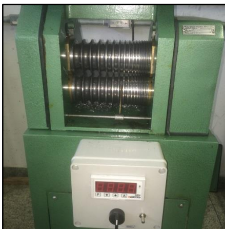
Figura 18 - Laminador duo elétrico MENAC usado na fabricação dos corpos de prova.
