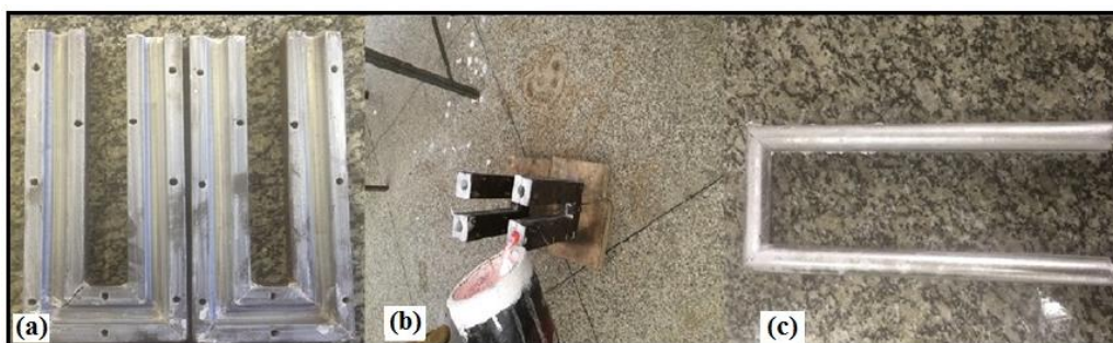
Figura 17 - Imagens do molde em coquilha (a), do vazamento do metal líquido (c) e o metal solidificado desmoldado.
