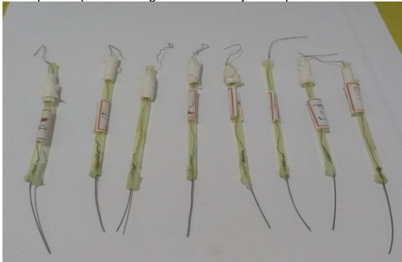
Figura 14 corpos de prova das ligas de NiTi e Aço Inox para ensaios eletroquímicos
