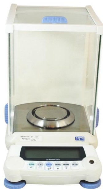
Figura 1620: Pesagem das amostras, balança de 5 dígitos, modelo SHIMADZU – AUW220D
