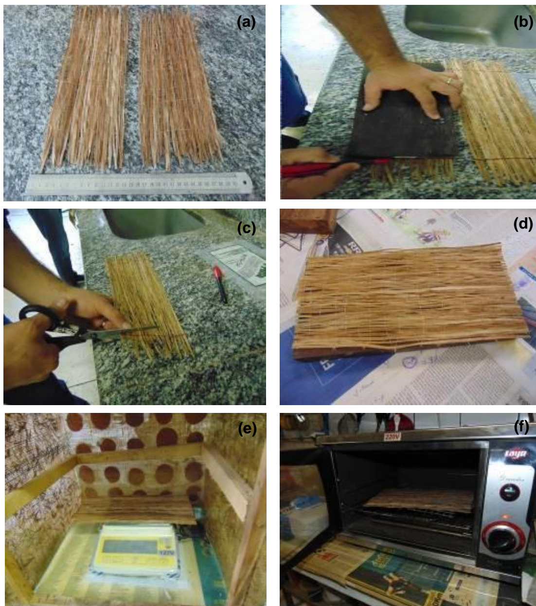
Figura 26: (a), (b), (c), (d), (e) e (f). Procedimento de ajuste e pesagem das pré-pregs de fibras.
