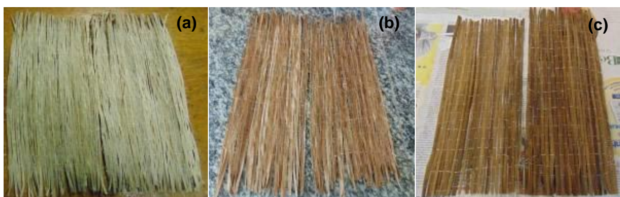
Figura 21: Pré- pregs de: (a) Pente de Macaco, (b) Mutamba e (c) Pindaíba confeccionadas no Tear
