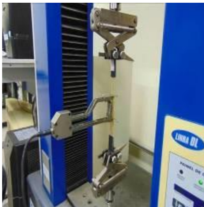
Figura 42: Montagem para realização do ensaio na máquina universal de ensaios da marca EMIC DL 10000.
