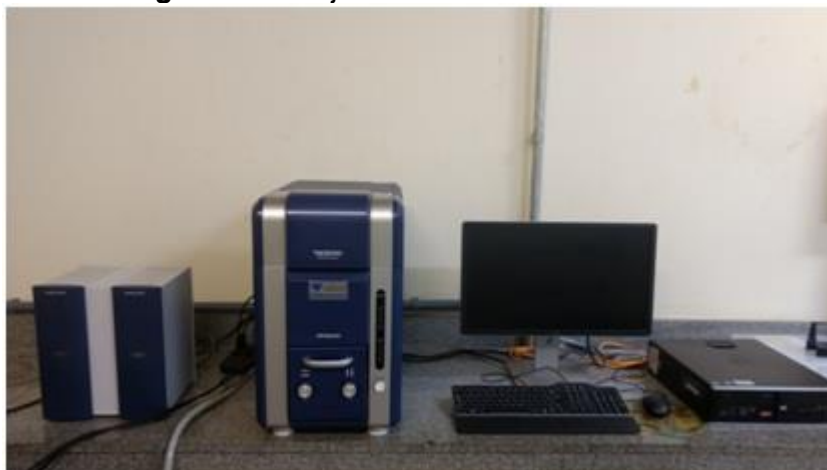
Figura 23: Conjunto de bancada MEV / EDS
