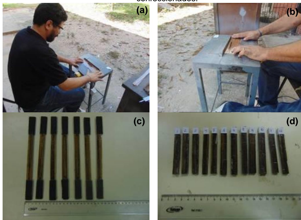
Figura 33: (a), (b), (c) e (d). Usinagem e os corpos de prova de tração e impacto confeccionados.
