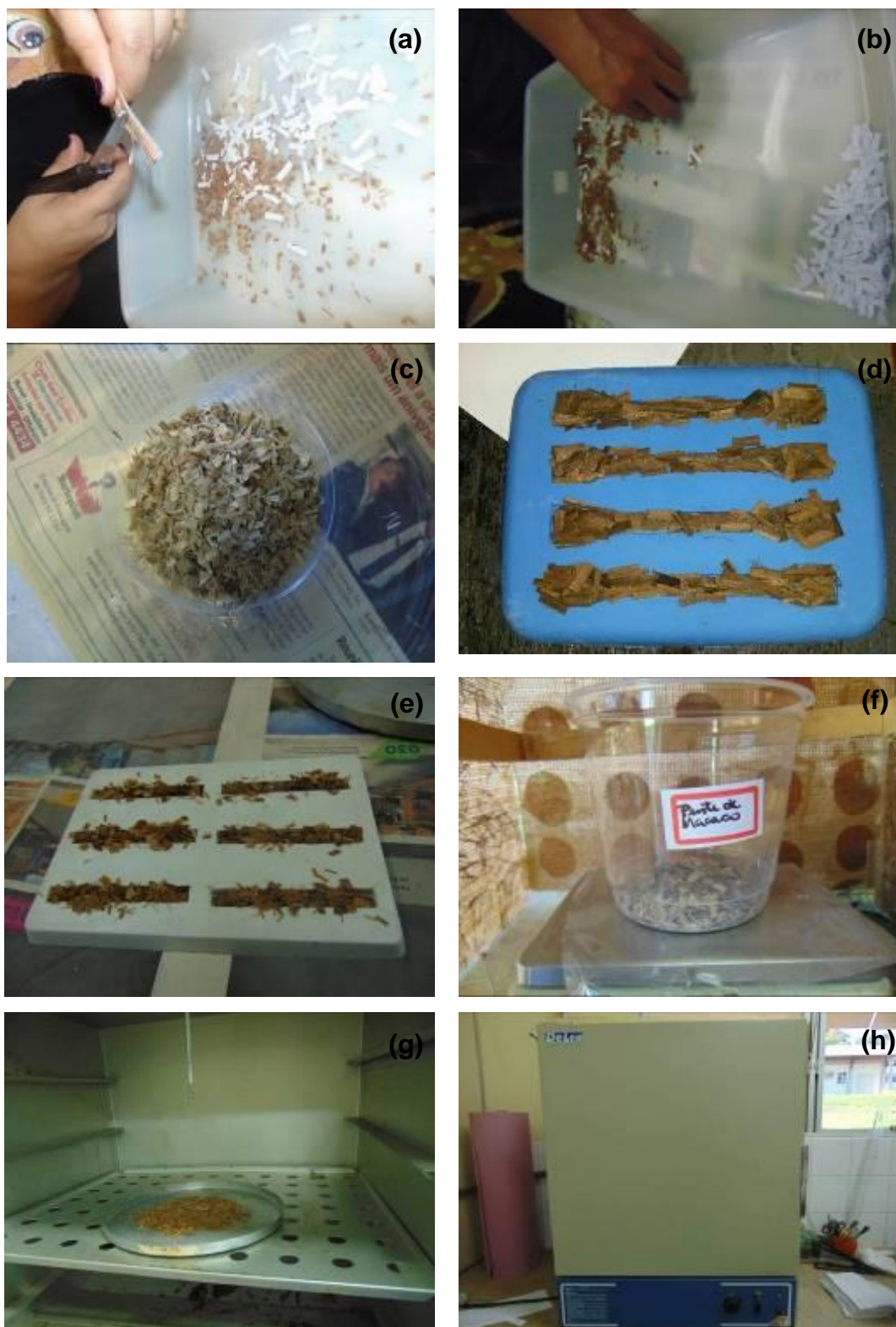
Figura 34: (a), (b), (c), (d), (e), (f), (g) e (h). Passo a Passo para preparação das fibras para a produção dos corpos de prova
