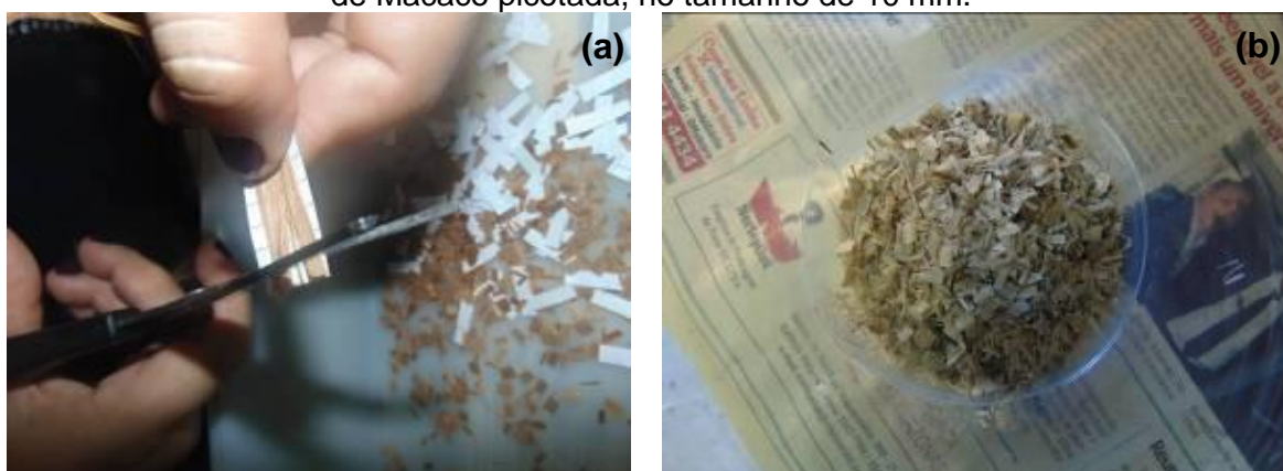
Figura 22: (a) Fibra de Mutamba sendo picotada no tamanho de 5 mm, (b) Fibra de Pente de Macaco picotada, no tamanho de 10 mm.
