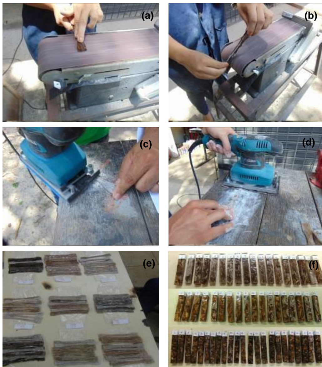
Figura 38: (a), (b), (c), (d), (e) e (f) Processo de usinagem ou lixamento dos corpos de prova
