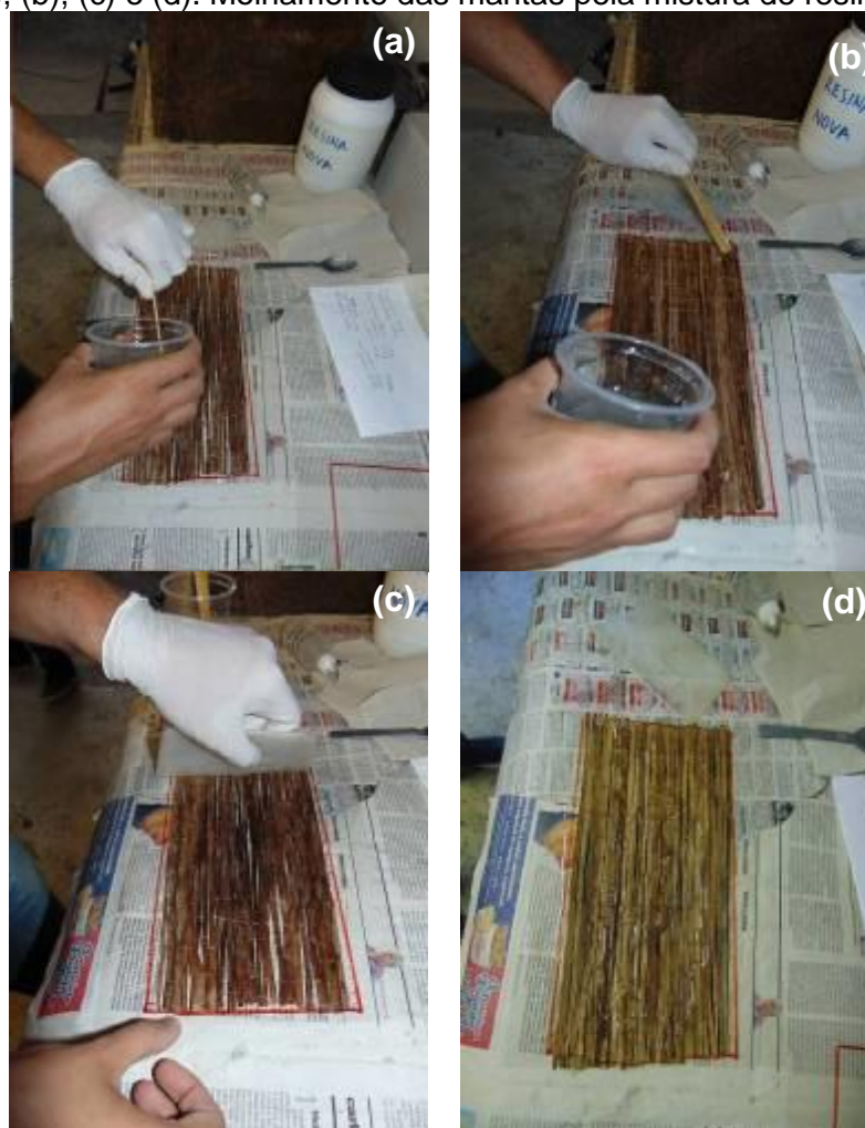
Figura 30: (a), (b), (c) e (d). Molhamento das mantas pela mistura de resina e catalisador
