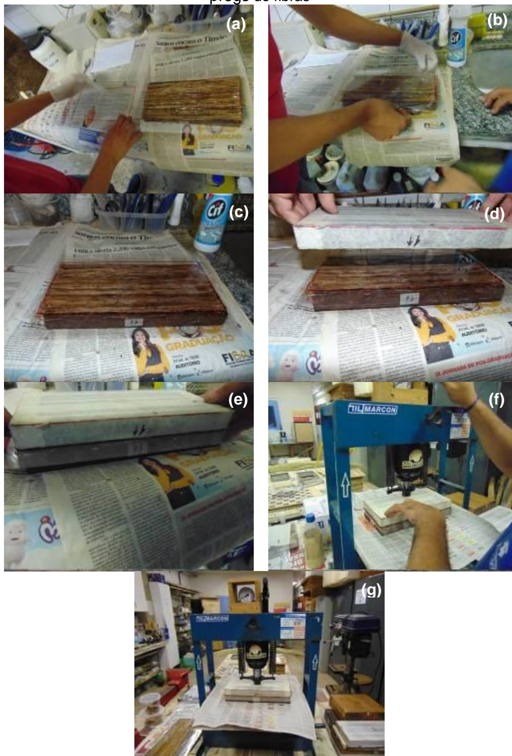
Figura 31: (a), (b), (c), (d), (e), (f) e (g). Procedimento de fabricação das pré-pregs de fibras
