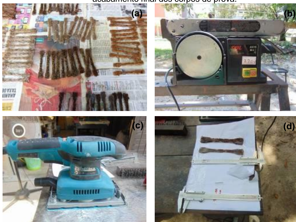
Figura 37: (a), (b), (c) e (d). Corpos de provas, as lixadeiras, os paquímetros utilizados no acabamento final dos corpos de prova.
