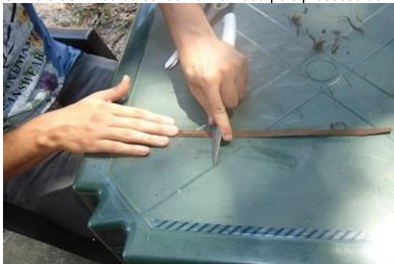
Figura 19: Fibra de Pindaíba sendo normalizada pelo processo de raspagem.
