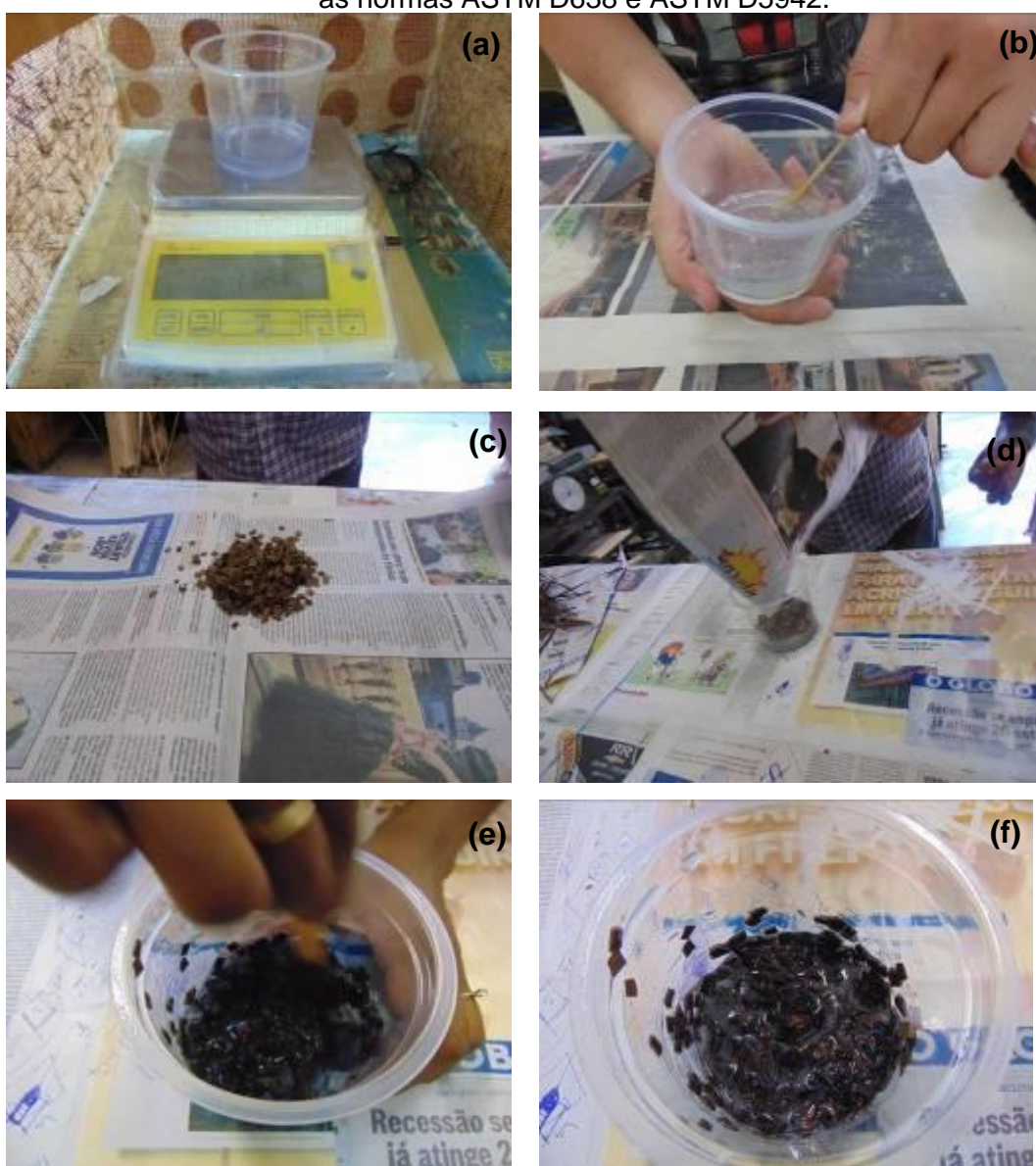
Figura 35: (a), (b), (c), (d), (e) e (f). Preparação e confecção dos corpos de prova segundo as normas ASTM D638 e ASTM D5942.
