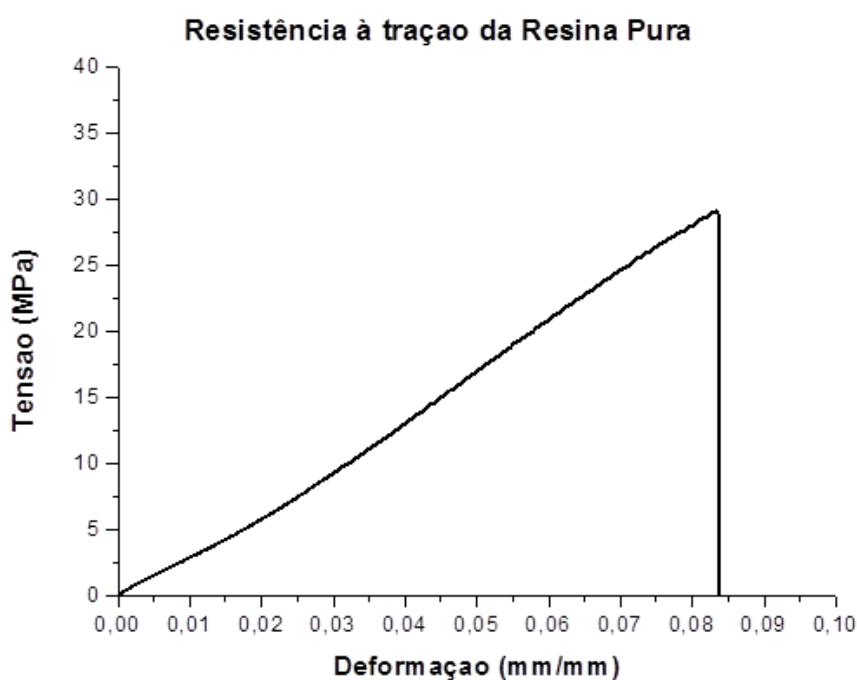
Figura 52: Curvas tensão versus deformação do corpo de prova da resina pura.
