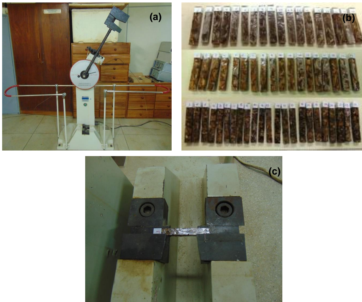
Figura 46: (a) Máquina de ensaio de impacto Charpy, (b) Corpos de prova em conformidade com a norma ASTM D5942 e (c) Montagem do corpo de prova no dispositivo de ensaio.
