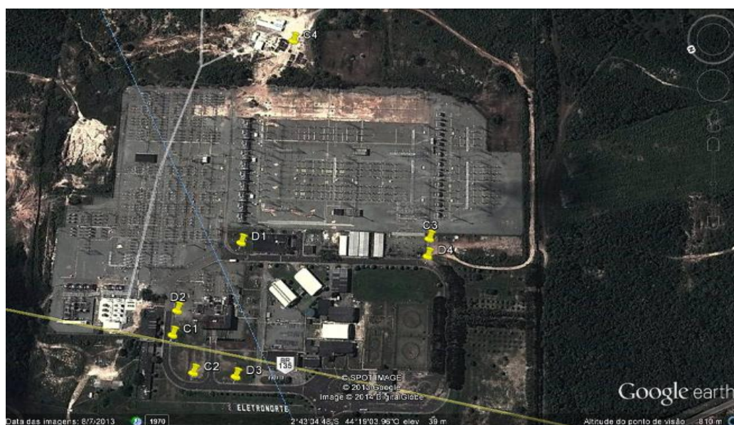
Figura 18: Localização geográfica de instalação dos cupons cilíndricos de aço carbono 1020 na ECA SEVC: pontos C1, C2, C3 e C4.
