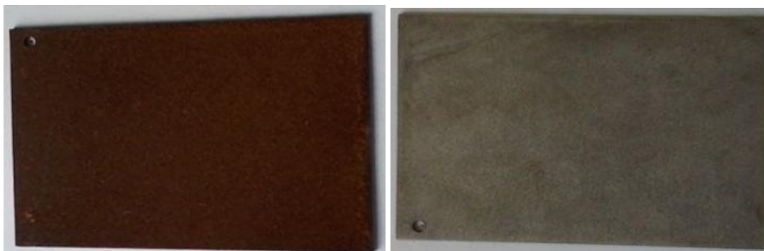
Figura 34: Placas de aço carbono 1020 antes da limpeza química (esquerda) e depois da limpeza química (direita) realizada no laboratório de corrosão da ELETRONORTE.
