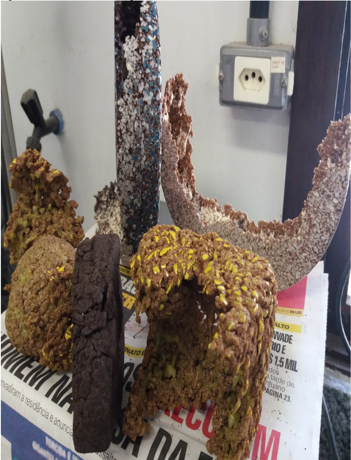
Figura 46 – Insucessos de rotomoldagem
