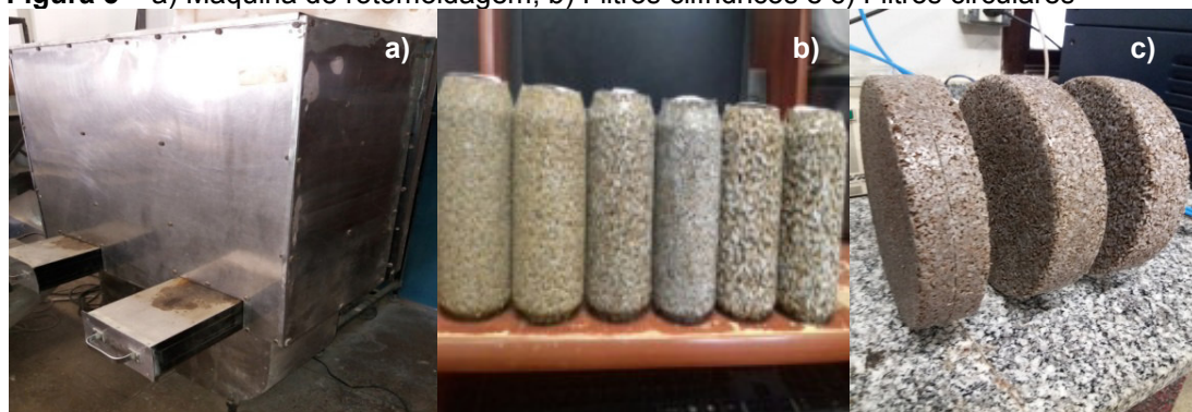
Figura 5 – a) Máquina de rotomoldagem; b) Filtros cilíndricos e c) Filtros circulares
