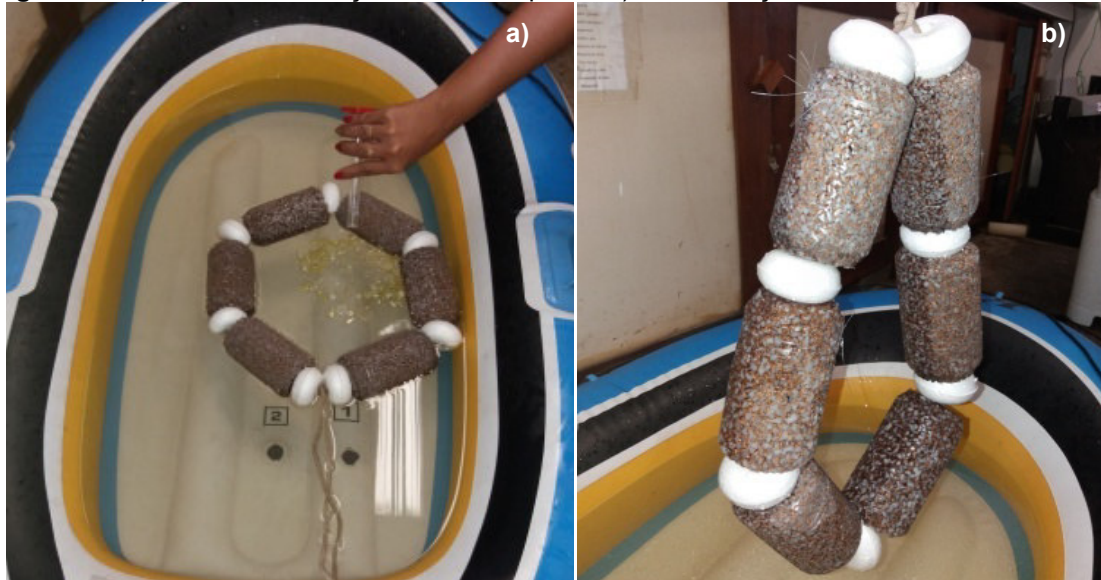
Figura 7 – a) Ensaio de adsorção em escala piloto; b) Quantificação de óleo adsorvido
