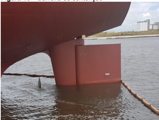
Figura 10 – Barreira de contenção
