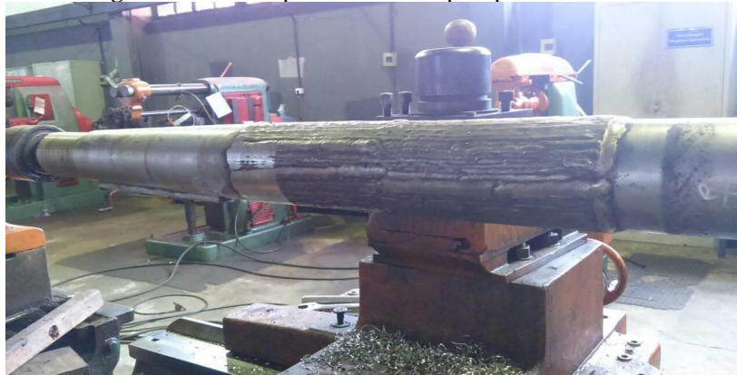
Figura 1 - Eixo Propulsoe revestido pelo processo SMAW
