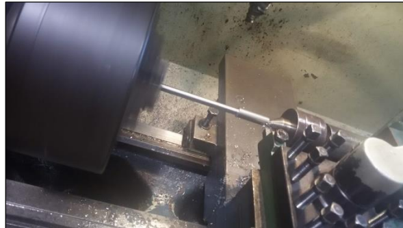
Figura 16 - Usinagem do Corpo de Prova
