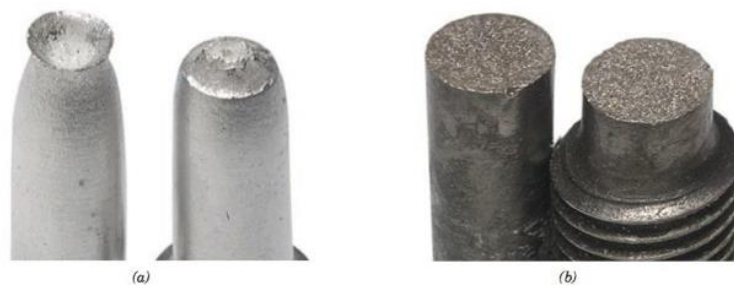
Figura 4 - Fratura do tipo taça e cone (a), Fratura frágil (b).
