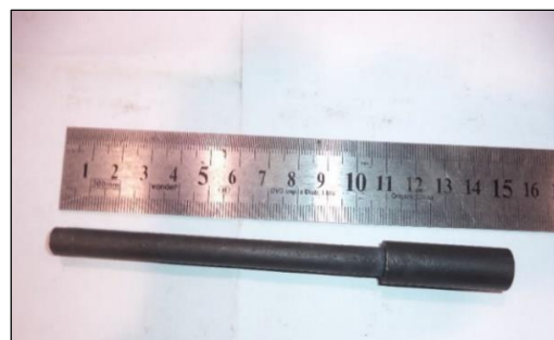
Figura 21 - Corpos de Prova para Ensaio de Fadiga Normalizado
