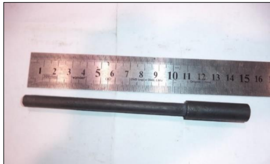
Figura 24 - Corpos de Prova para Ensaio de Fadiga Normalizado e Cementado
