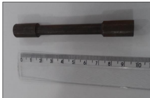
Figura 20 - Corpo de Prova Para Ensaio de Tração Normalizados
