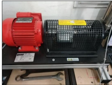
Figura 29 - Máquina de Fadiga por Flexão Rotativa do IFPA
