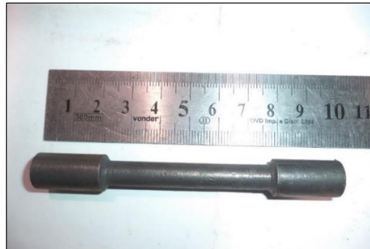
Figura 23 - Corpos de Prova para Ensaio de Tração Normalizado e Cementado
