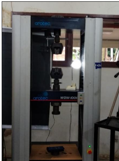
Figura 28 - Máquina de ensaio de tração do IFPA
