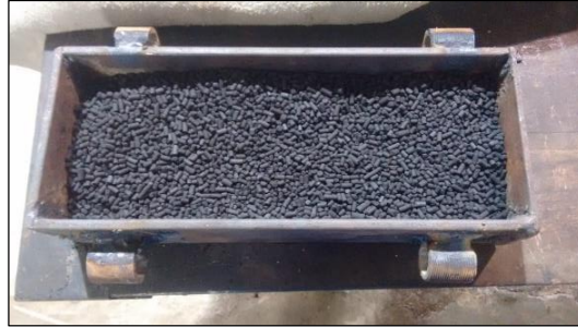
Figura 22 - Caixa com Carbono para Tratamento de Cementação
