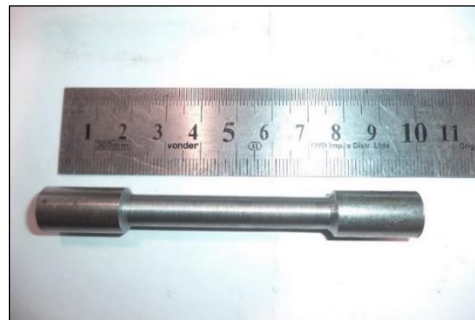
Figura 17 - Corpo de Prova trefilado para ensaio de tração
