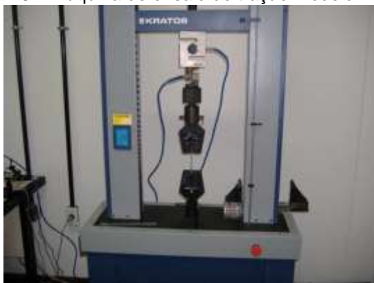
Figura 23 - Máquina de ensaio de tração modelo KRATOS
