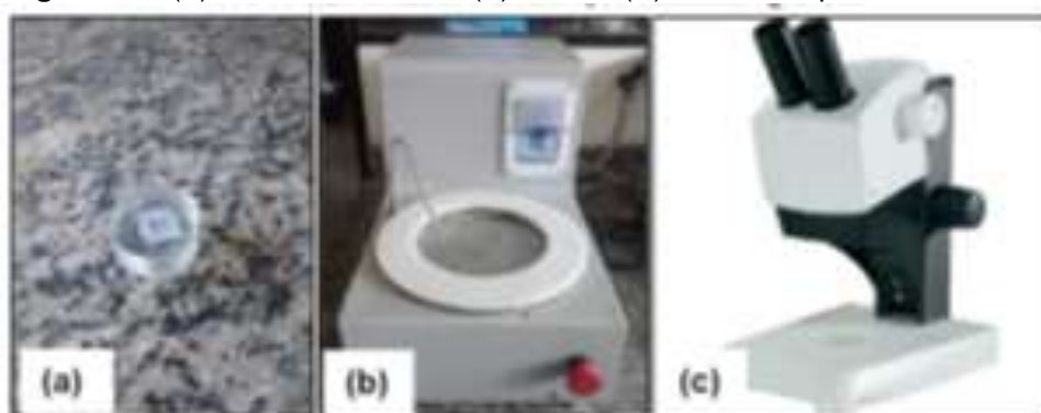
Figura 21 - (A) Amostra embutida; (B) Politriz; (C) Estereoscópio Leica Mod:Ez4
