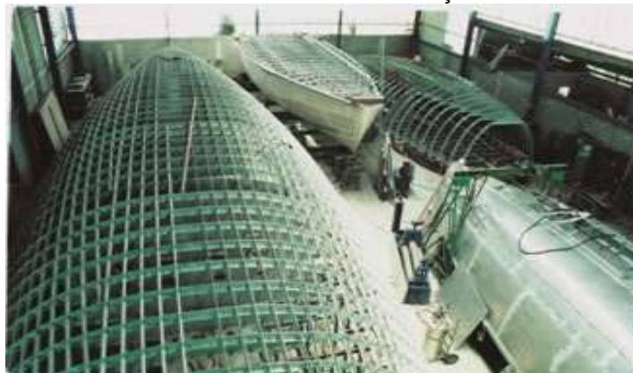
Figura 2 - Detalhe construtivo de uma embarcação convencional
