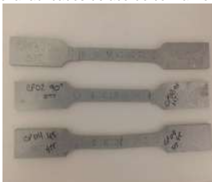
Figura 24 - Corpos de Prova fabricados de acordo com a Norma ABNT NBR 7549:2008
