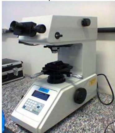
Figura 22 - HV-1000B para ensaios de microdureza
