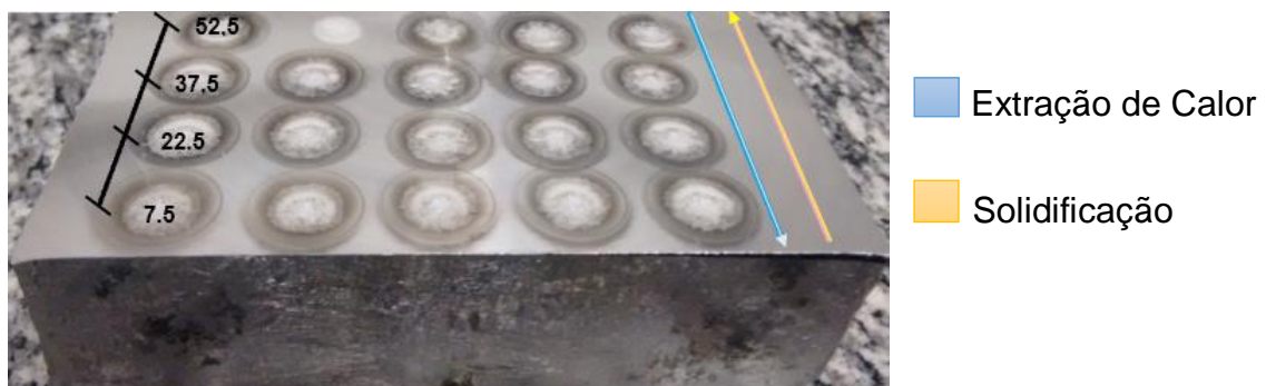
Figura 3.6 - Lingote após ensaio de Rejeição de soluto.
