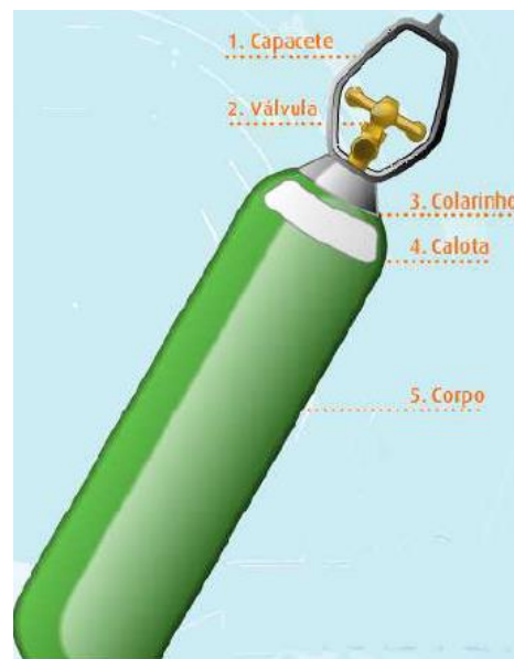
Figura 4 - Componentes dos cilindros
