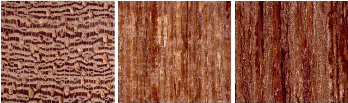
Figura 3 - Fotomicrografia da madeira de Erisma uncinatum a) plano transversal, b) radial e c) tangencial e com aumento de 20 x e escala de 1mm
