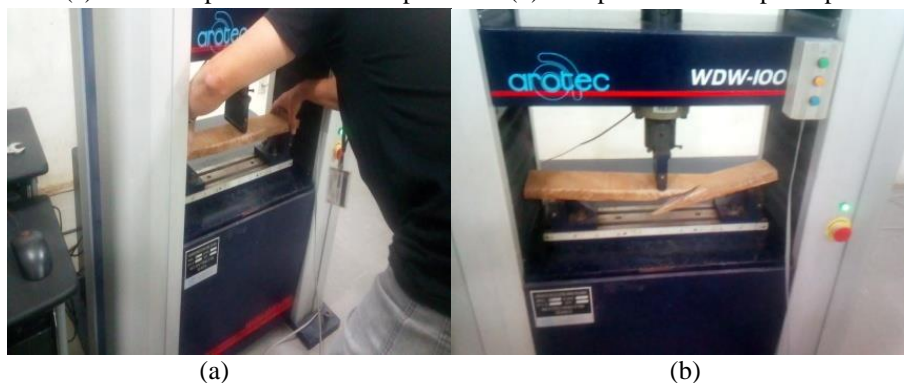
Figura 19 - (a) Ensaio experimental de compressão e (b) Rompimento do corpo de prova
