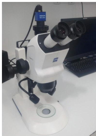
Figura 3.15 – Esteroscópio ZEISS STEMI 508.
