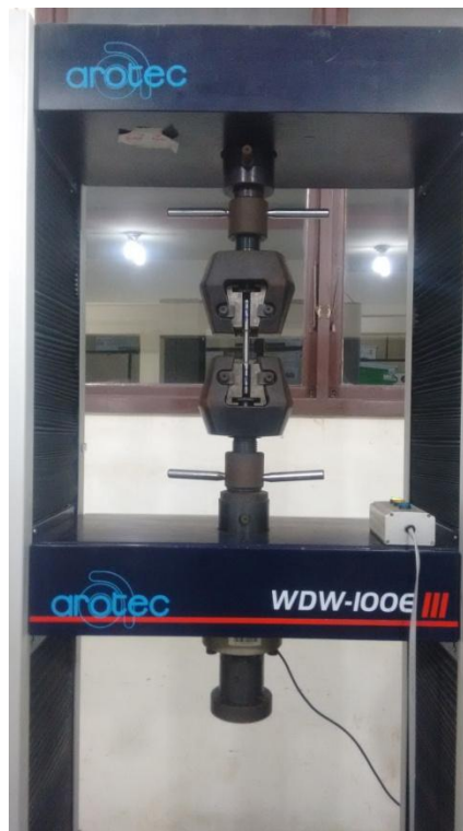
Figura 3.10 – Máquina universal para ensaios AROTEC WDW-100E.
