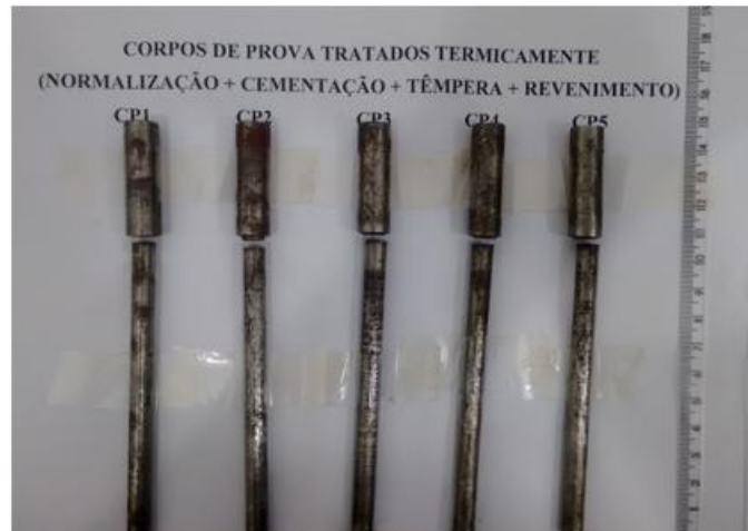
Figura 4.14(c) – Corpos de prova NCTR após o ensaio de fadiga flexo-rotativa.
