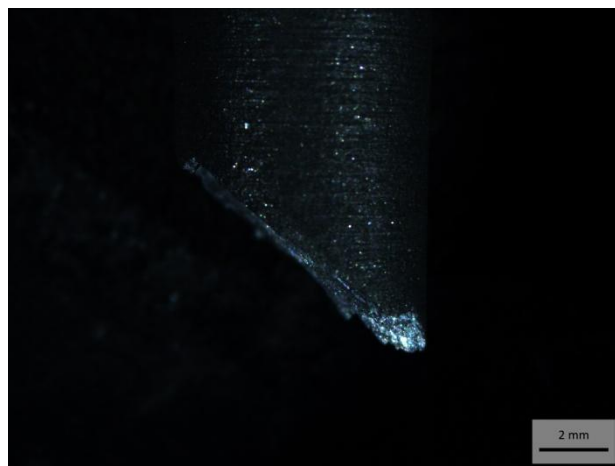
Figura 4.6(b) – Perfil de fratura frágil no corpo de prova NC01.
