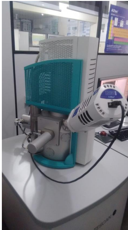
Figura 3.16 – Microscópio Eletrônico de Varredura.
