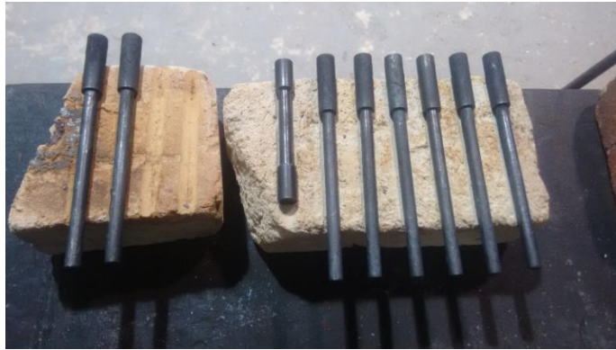
Figura 3.8 – Corpos de prova para o tratamento de têmpera.
