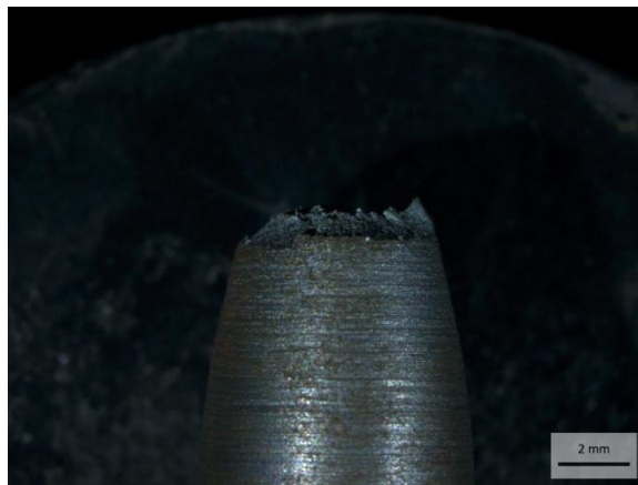
Figura 4.3(c) - Fractografia do corpo de prova ST03 destacando o perfil de fratura dúctil na amostra inferior.
