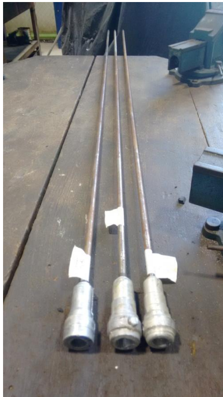
Figura 3.3 – Eixos de rabeta para a fabricação dos corpos de prova.
