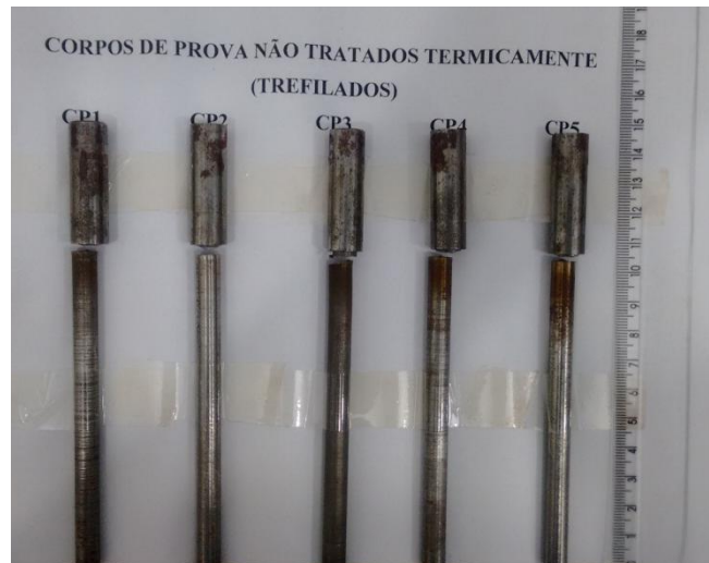
Figura 4.14(a) – Corpos de prova ST após o ensaio de fadiga.
