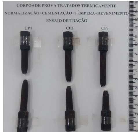
Figura 4.9 – Corpos de prova NCTR após o ensaio de tração.
