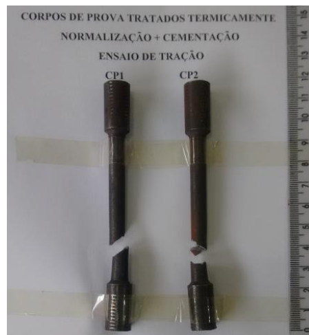
Figura 4.5 – Corpos de prova NC após o ensaio de tração.
