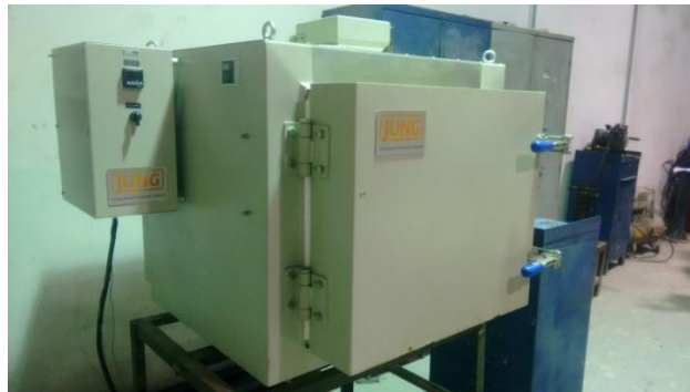
Figura 3.6 – Forno mufla para tratamentos térmicos JUNG.
