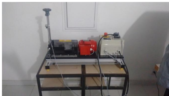
Figura 3.12 – Equipamento para ensaio de fadiga GUNT HAMBURG WP140.
