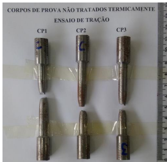
Figura 4.2 – Corpos de prova ST após o ensaio de tração.
