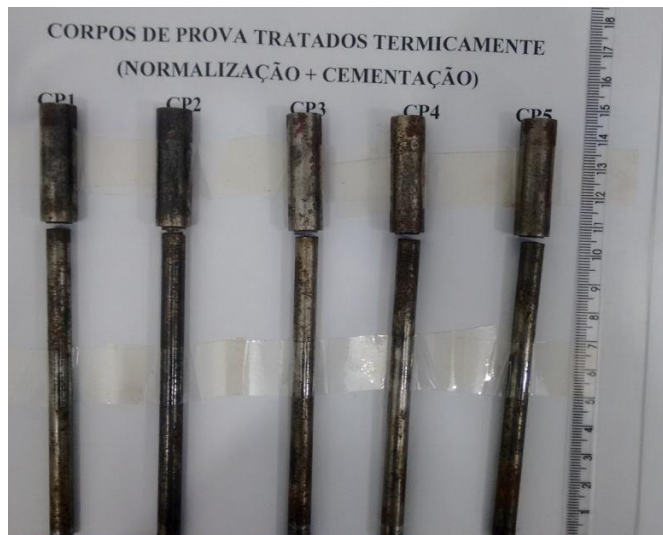
Figura 4.14(b) – Corpos de prova NC após o ensaio de fadiga flexo-rotativa.
